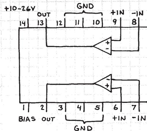
NOTE: GND PINS SHOULD BE HEAT SUNK FOR MAXIMUM POWER.
