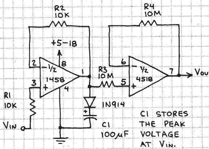
$C_1$  STORES THE PEAK VOLTAGE AT  $V_{in}$ .
