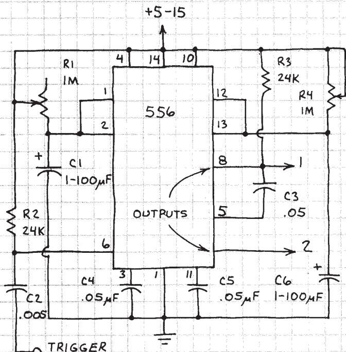
BOTH TIMERS ARE IN ONE-SHOT MODE. GROUNDING THE TRIGGER INPUT INITIATES THE FIRST TIMER'S CYCLE TIME. THE SECOND TIMER'S CYCLE BEGINS AFTER THE FIRST IS COMPLETE.
