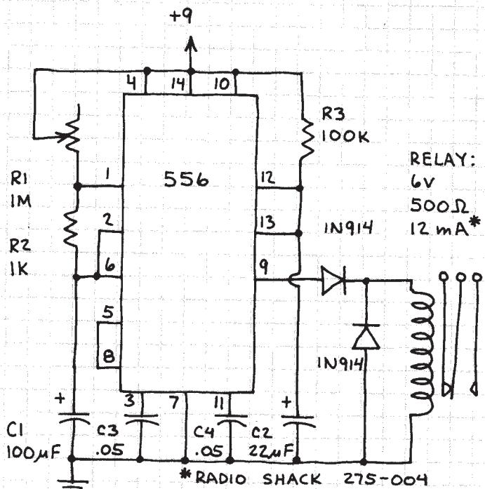
TIMER 1 IS CONNECTED AS ASTABLE OSCILLATOR. TIMER 2 IS A ONE-SHOT RELAY DRIVER. 1 FIRES 2 ONCE EACH CYCLE. 2 PULLS RELAY IN FOR 3-5 SECONDS.
