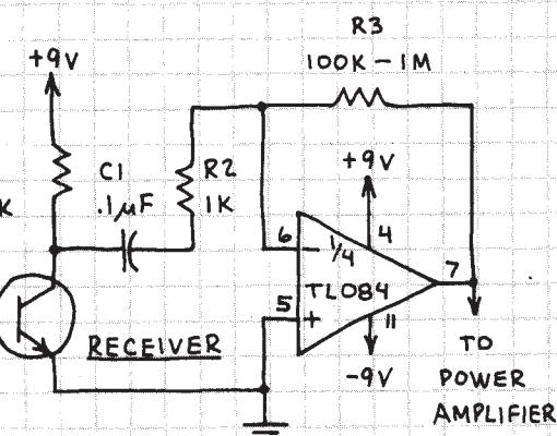
USE RADIO SHACK 276-130 PHOTOTRANSISTOR FOR Q1. MAXIMUM RANGE: HUNDREDS OF FEET AT NIGHT WITH LENSES AT Q1 AND LED. POWER AMP: SEE LM386.
