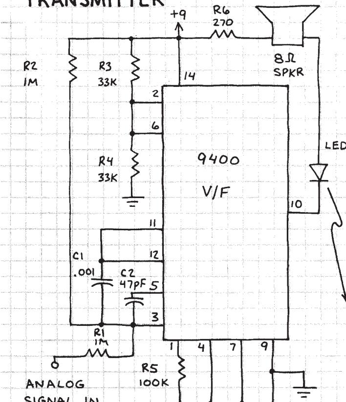
THE SPKR IS OPTIONAL BUT MAY PROVE HELPFUL DURING INITIAL TESTING. USE AN INFRARED LED (RADIO SHACK 276-142). Q1 CAN BE THE PHOTOTRANSISTOR SUPPLIED WITH THE LED OR RADIO SHACK 276-130. R7 IN THE RECEIVER IS ZERO ADJUST.
